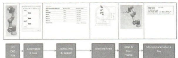
Hình 4. Các bước xây dựng mô hình số rô bốt UR3
