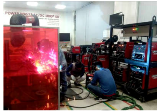
Hình 2. Thiết bị PLEXTEC ® 500x của hãng LINCOLN dùng cho thí nghiệm hàn giáp mối thép tấm dày với khe hở hẹp có góc vát mép nhỏ: a) Toàn cảnh hệ thống thiết bị hàn; b) Điều chỉnh chế độ hàn thí nghiệm; c) Hàn thử mẫu theo chế độ quy hoạch thực nghiệm
