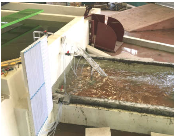
Hình 2. Kết cấu xi phong trong thí nghiệm vật lý (Phạm Văn Khôi và Vũ Văn Nghi, 2021) và trong thí nghiệm mô phỏng
