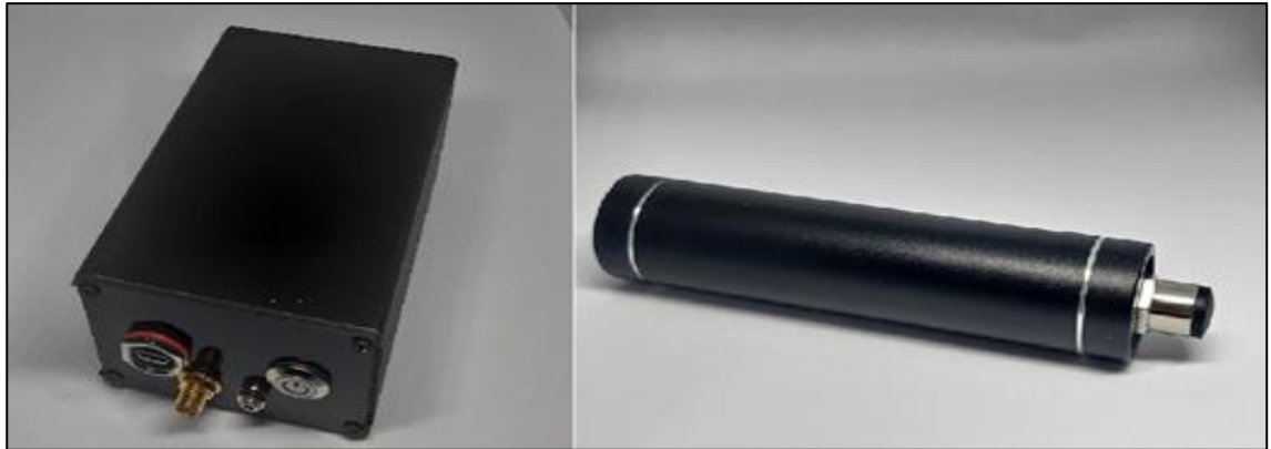
Hình 2. Máy đo đơn kênh (trái) và đầu dò (phải)
