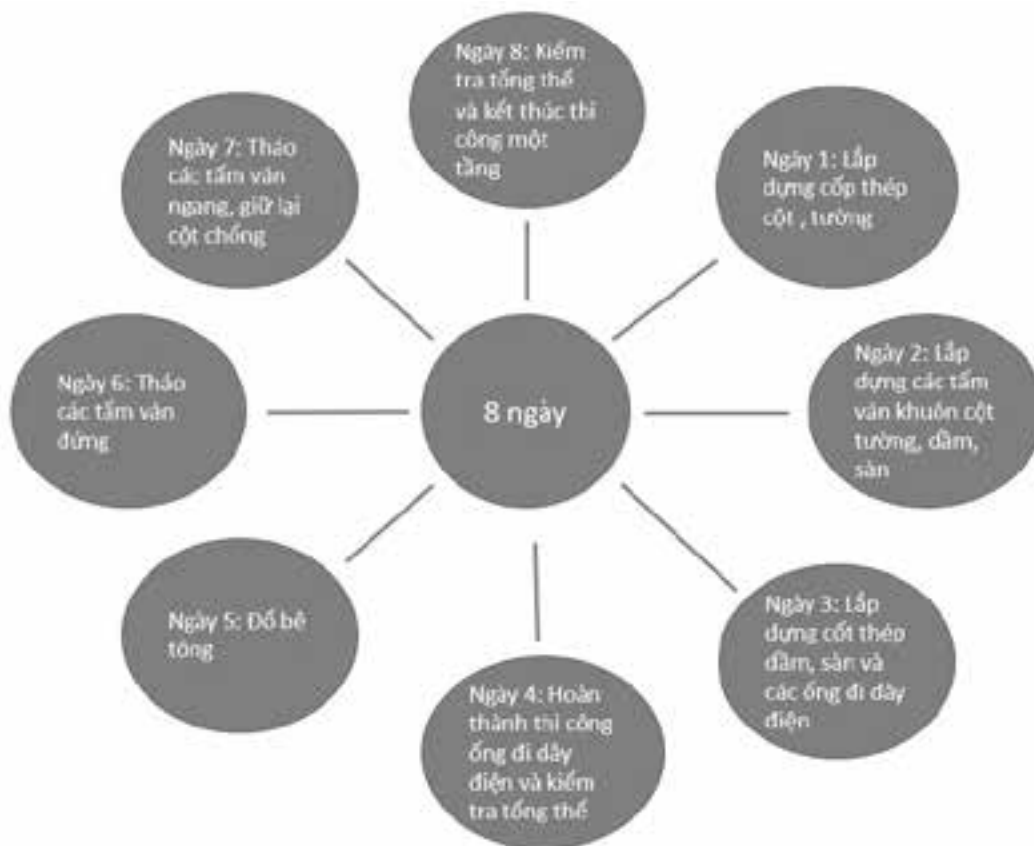
Hình 3.1. Sơ đồ tiến độ thi công coppha nhôm
