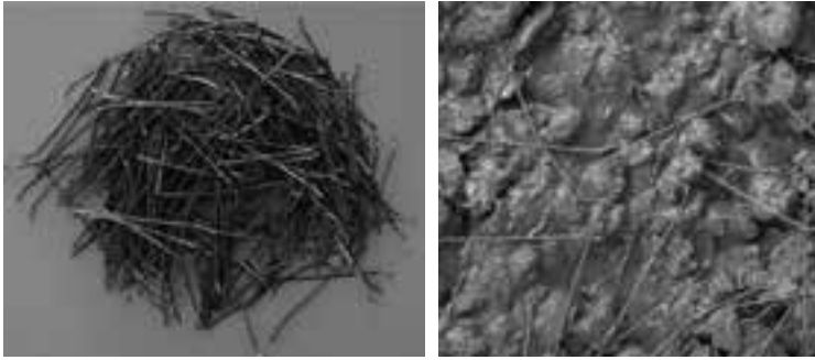
Hình 2. Hình ảnh về cốt sợi thép và bê tông cốt sợi thép
