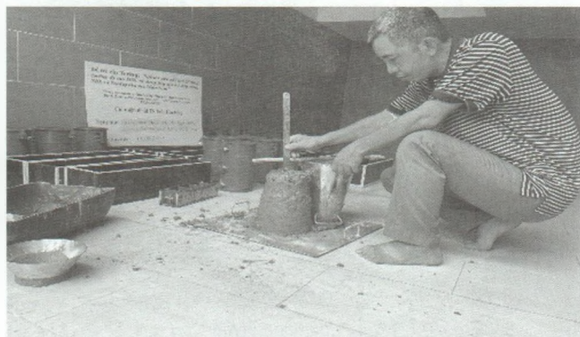
Hình 3.1: Xác định độ sụt của hỗn hợp bê tông HSC sử dụng NS và FA
