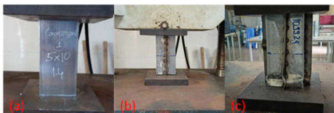
Hình 1. a) Ống chữ nhật, b) Ống chữ nhật với 2 gân tăng cứng và c) Ống chữ nhật với 4 gân tăng cứng
