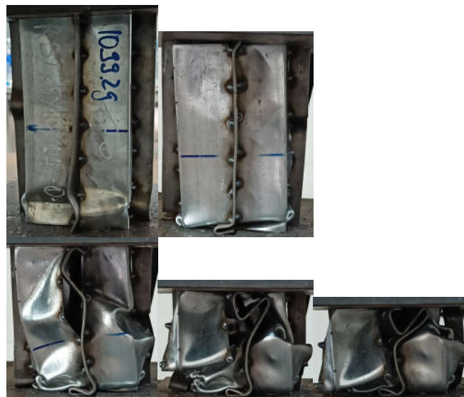
Hình 5. Quá trình nén của ống chữ nhật với 4 gân tăng cứng
