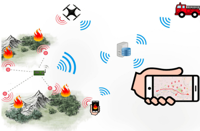
Hình 5. Sơ đồ phát hiện cháy rừng thông qua cảm biến và blockchain
