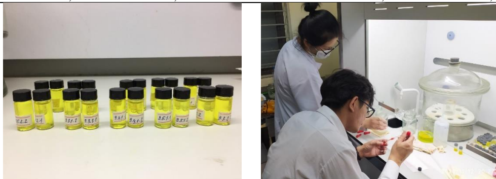
Hình 1. Quá trình thực hiện thí nghiệm đo chiều dài sợi gỗ Keo lá trà
