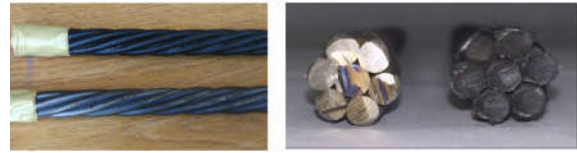
Hình 4a-b. Hình ảnh bên ngoài của cáp CFRP (trên) và cáp thép (dưới); Hình ảnh lát cắt ngang của cáp CFRP (phải) và cáp thép (trái).
