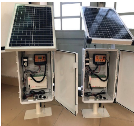
Hình 3. Nốt cảm biến được thiết kế dạng tủ kín, sử dụng pin năng lượng mặt trời để đảm bảo hoạt động tốt ở cả những khu vực hẻo lánh.
