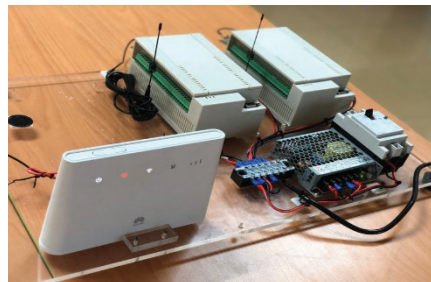
Hình 2. Các điểm thu thập dữ liệu có chức năng thu thập dữ liệu từ các nốt cảm biến, sau đó chuyển dữ liệu về máy chủ.
