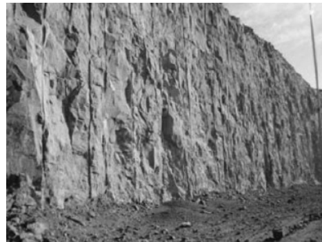
Hình 1. Kết quả nâng cao góc dốc sườn tầng theo phương pháp nổ tạo biên tại mỏ quặng Aitik, Thụy Điển [1]
