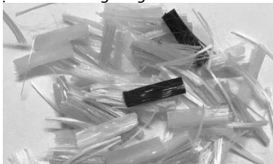
Hình 3 - Sợi Forta-fi trong điều kiện bình thường trước khi trộn vào hỗn hợp
