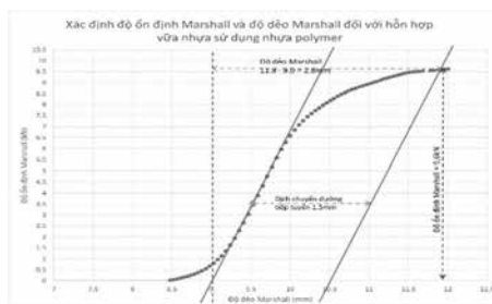
Hình 8 - Biểu đồ xác định độ ổn định và độ dẻo Marshall đối với hỗn hợp vữa nhựa sử dụng nhựa polymer
