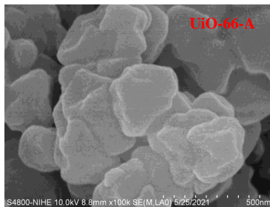
Hình 5: Ảnh SEM của vật liệu UiO-66 và UiO-66-A
