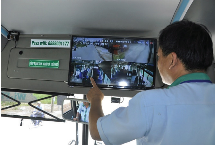
Camera hành trình theo TCVN13396:2021 được tích hợp nhiều mắt thu hình ảnh.
