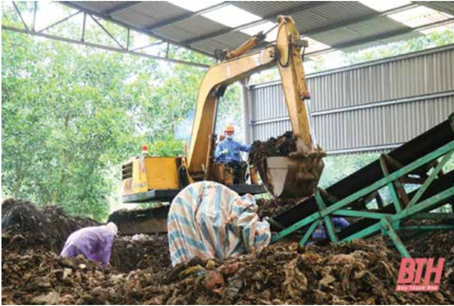
▲ Sau thời gian ủ, trộn xử lý, rác thải sinh hoạt được đưa vào hệ thống phân loại rác
