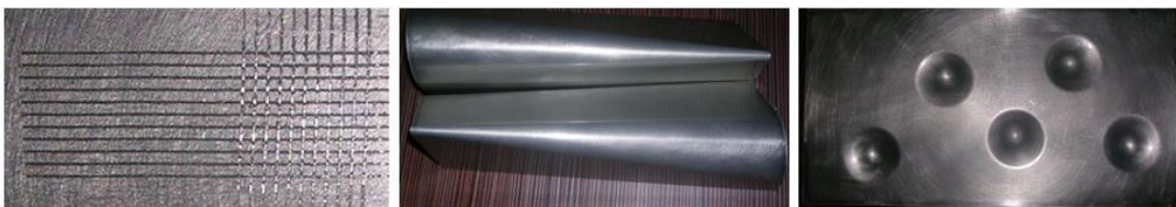
Hình 9. Màng sơn trên kim loại sau khi thử cơ tính
