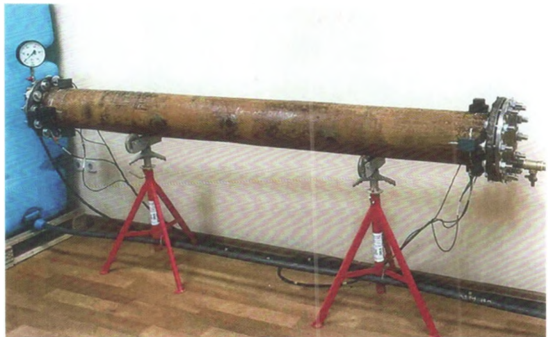
Hình 3. Mẫu thử kiểm tra bằng PDT.
