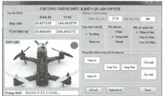
Hình 3.1: Giao diện chương trình điều khiển và thu thập dữ liệu cảm biến
