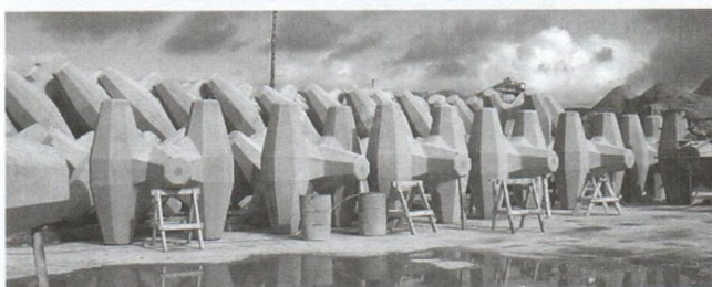
Hình 2.7: Cấu kiện Core-Loc 1994 (US Corps)
