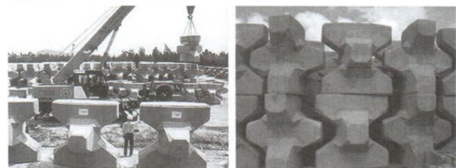
Hình 2.5: Accropode tại xưởng đúc
