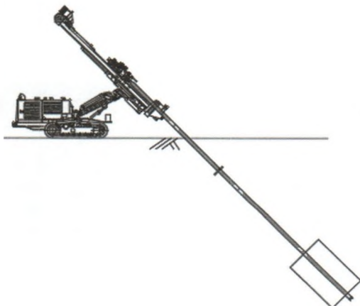
Hình 3.3: Khoan bằng cần khoan phụ
