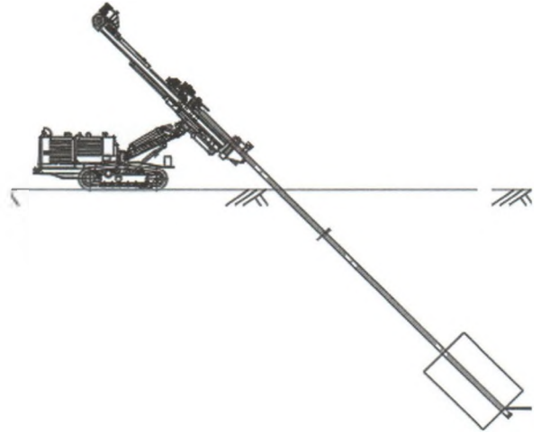
Hình 3.4: Chuẩn bị phụt vữa gia cố nền
