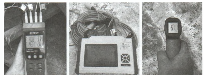
Hình 2.1: Các thiết bị thí nghiệm đo nhiệt sử dụng
