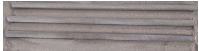
Hình 6: Gia công phủ lớp cát mặt ngoài của cọc
