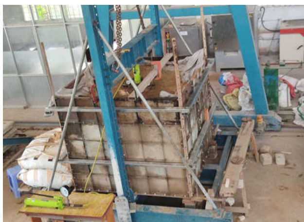
Hình 7: Mô hình thùng chứa đất thí nghiệm nén hệ móng bè-cọc
