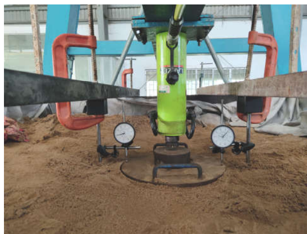
Hình 8: Thí nghiệm xác định mô đun của đất nền[2]
