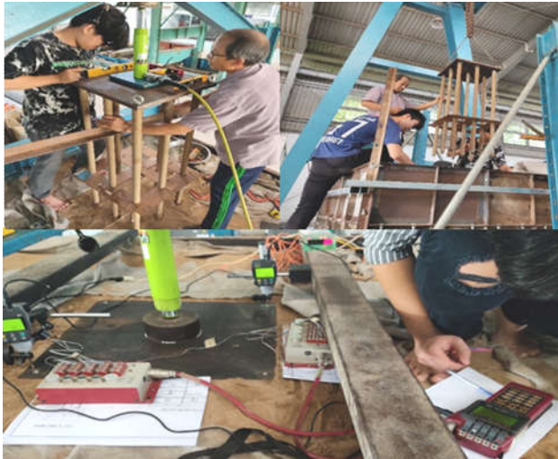
Hình 9: Lắp đặt thiết bị quan trắc, đo biến dạng dọc thân cọc
