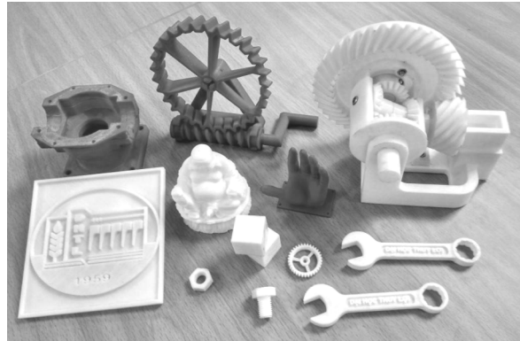
Hình 6. Một số sản phẩm in 3D của máy in 3D hai đầu phun
