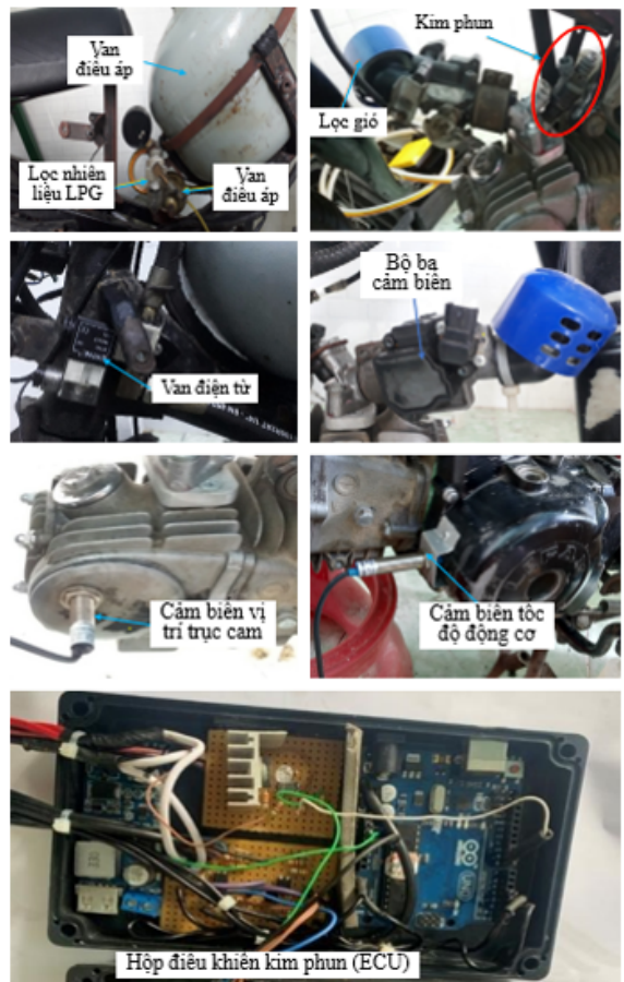
Hình 8: Hình ảnh các chi tiết của hệ thống phun nhiên liệu LPG sau khi chế tạo
