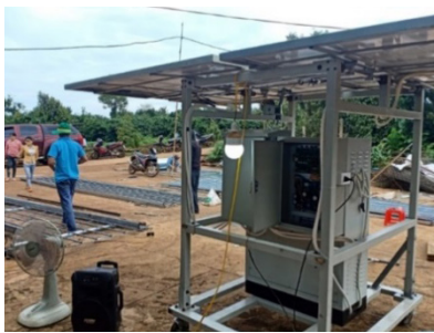
H.6. Mô hình thực nghiệm đánh giá hiệu suất hệ thống nguồn pin mặt trời dựa trên cấu trúc mạch tăng áp DC-DC mới đề xuất
