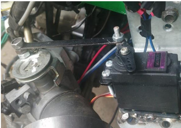
Hình 13. Motor servo lắp đặt để kéo bướm ga
