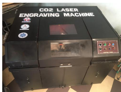
Hình 19. Máy khắc CNC laser CO 2 , sau khi chế tạo.
