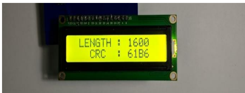
Hình 12. Kết quả tính toán CRC của bộ mã hóa với block dữ liệu dài 1600 bit.
