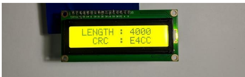
Hình 11. Kết quả tính toán CRC của bộ mã hóa với block dữ liệu dài 4000 bit.
