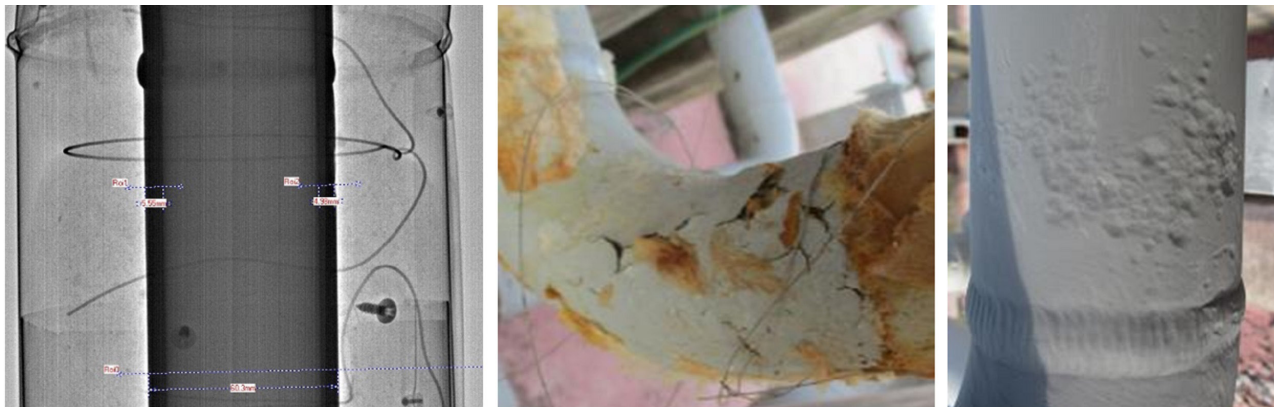
Vị trí ăn mòn PL-50-C1B-2521 được đo đạc bằng DR, bóc cách nhiệt xác nhận và sau khi xử lý
