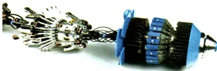
Hình 10. Thoi thông minh dùng để khảo sát đường ống.
