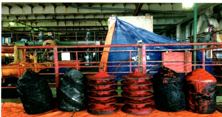
Hình 11. Các loại thoi đã sử dụng để làm sạch đường ống ngầm MSP-8 → MSP-9 mỏ Bạch Hổ.
