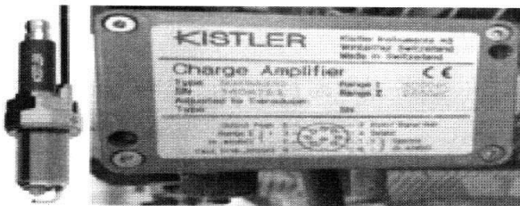
Hình 3. Thiết bị đo áp suất buồng cháy
