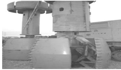
Hình 4: Hệ thống gầu khoan
