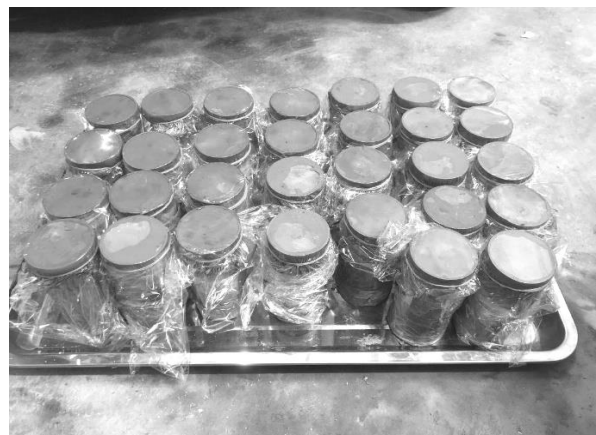
Hình 3. Mẫu sau khi đúc xong Bảo dưỡng mẫu soilcrete
