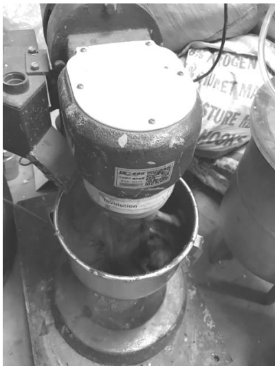
Hình 2. Vữa trong thau trộn máy
