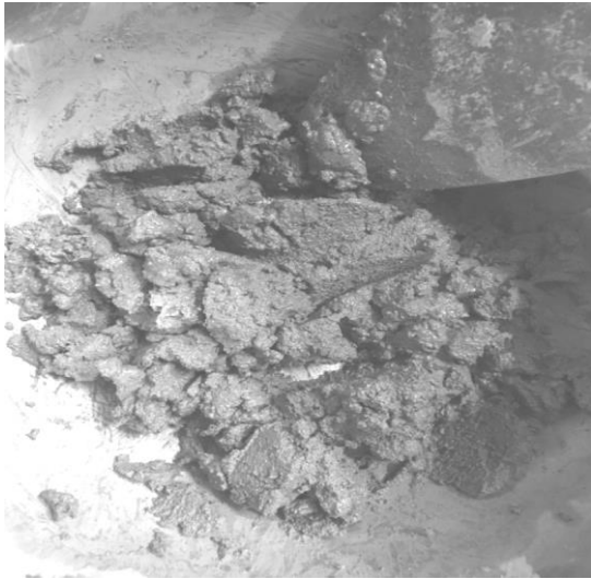
Hình 2. Trộn hỗn hợp cát - xi măng - bentonite với nước theo tỉ lệ w:BC = 0.7:1
