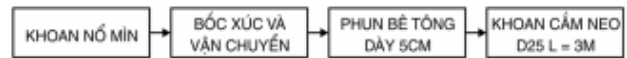
Hình 1. Trình tự thi công trong kết cấu chống đỡ loại B (đào toàn tiết diện)
