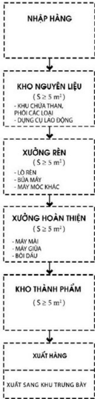
Hình 5. Dây chuyền cơ cấu chức năng trong sản xuất rên hiện đại. Nguồn: Tác giả
