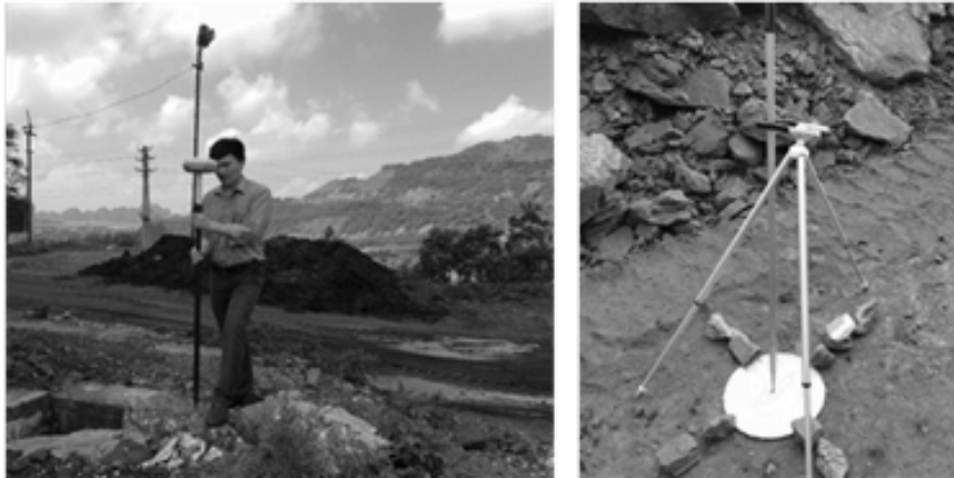
Hình 4. Thiết bị đo GNSS/RTK và tiêu đánh dấu điểm khống chế
