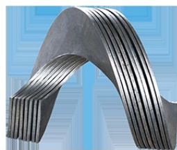
Hình 1. Dạng cánh vít trước và sau khi được hàn liên kết lại trên trục
