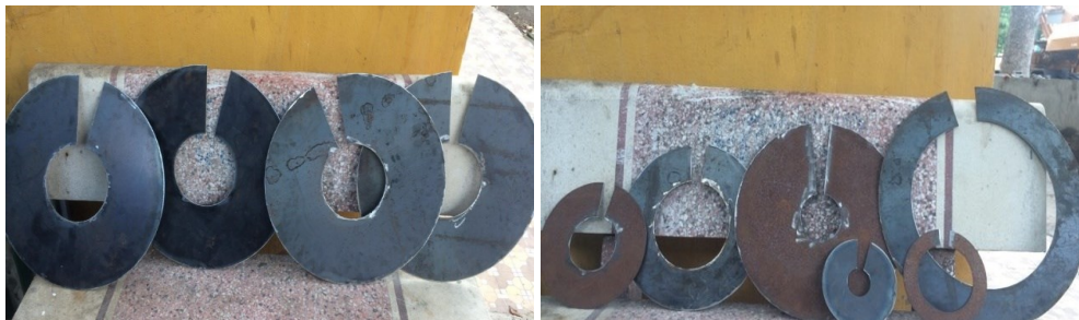
Hình 23. Các loại phôi khác nhau chuẩn bị cho quá trình uốn
