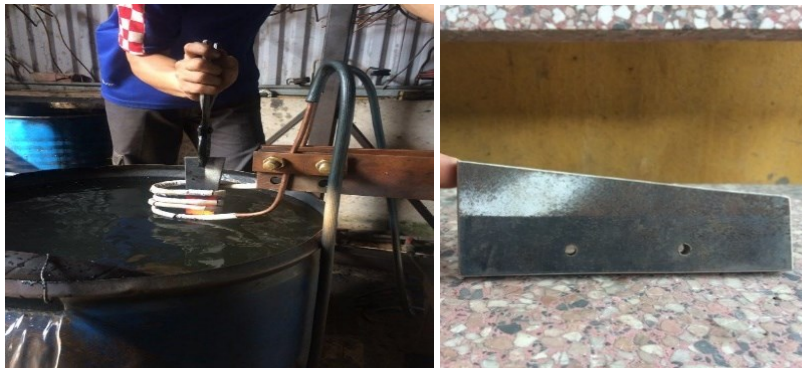
Hình 21. Nâng cao cơ tính của dao uốn bằng phương pháp tôi cao tần
