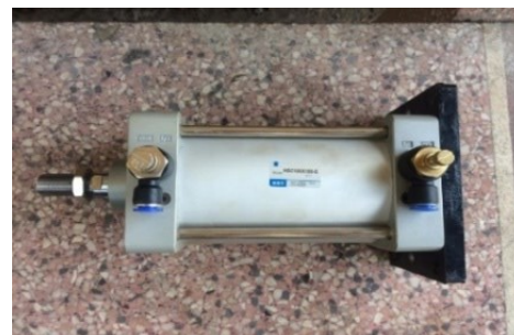
Hình 7. Sơ đồ chuyển hóa năng lượng khí nén thành lực và hình ảnh xilanh được lựa chọn
