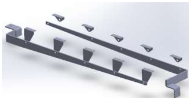
Hình 5. Các thanh dẫn tạo thành các điện cực được thiết kế trên solidworks
