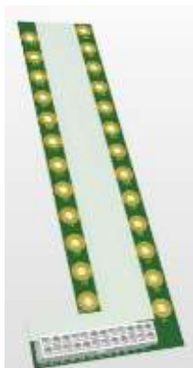
Hình 7. Mạch in thay thế dây nối từ các tế bào về BMS
