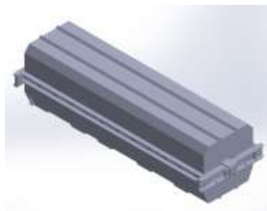
Hình 6. Khối nguồn hoàn chỉnh với nắp đậy và khung bảo vệ được thiết kế trên solidworks
