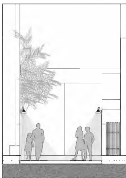
Hình 7. Mặt cắt đề xuất cải tạo hệ thống đèn chiếu sáng ban đêm cho ngõ đề xuất cải tạo
