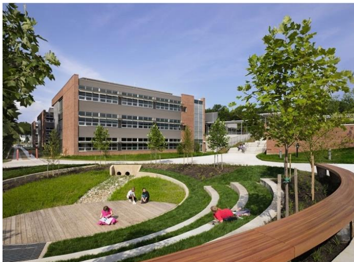
Hình 12. Khai thác địa hình để tạo cảnh quan và sân chơi cộng đồng, hạn chế lưu lượng nước chảy bề mặt và giảm áp lực về các hệ thống thu gom chung tại trường tiểu học thành phố Manassas Park, Virginia, Hoa Kỳ [20]
