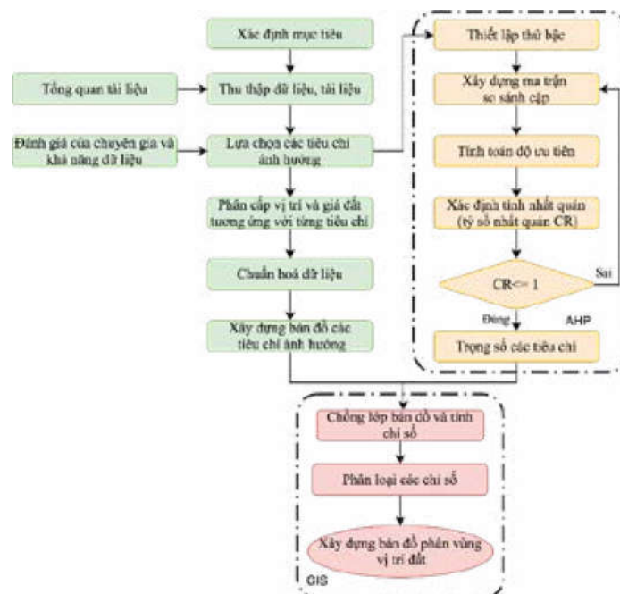
Hình 3: Quy trình thành lập bản đồ giá đất bằng phương pháp AHP và GIS
