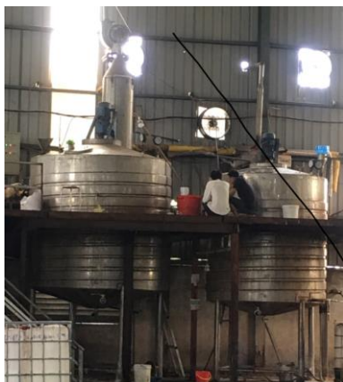
Hình 3. Thiết bị tổng hợp keo ở quy mô thực nghiệm 1.000 - 3.000 kg/m 3 (Công ty Cổ phần Việt Nhật Hi - Tech)
