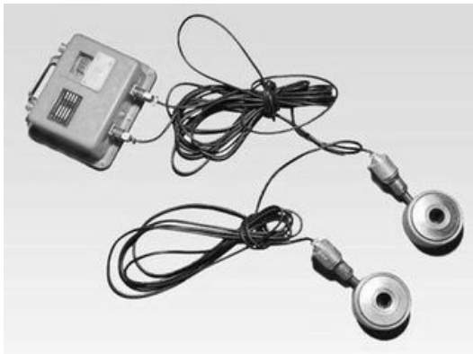
Hình 4. Thiết bị đo lực thanh neo MCZ
