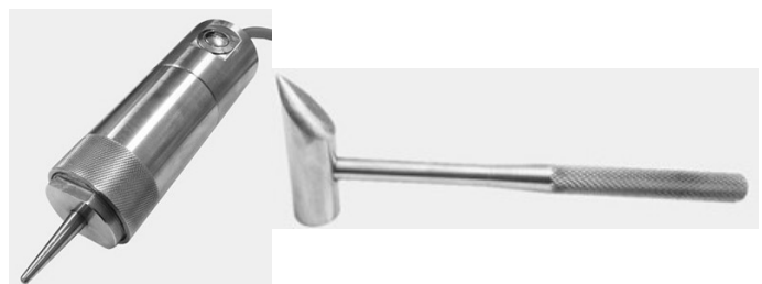
a) Máy chủ GD-RBT; b) Cảm biến gia tốc; c) Búa tay Hình 3. Hệ thống thiết bị kiểm tra chất lượng thanh neo (GD-RBT)
