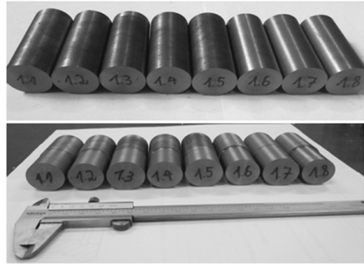
Hình 2. Mẫu thực nghiệm thép C45
