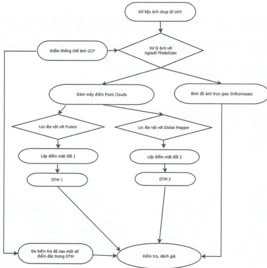
Hình 2.1: Quy trình tạo mô hình DTM tự động theo hai phương pháp và đánh giá mô hình
