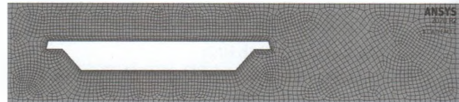
Hình 3.3: Mô hình lưới của luồng gió với kích thước lưới nhỏ nhất: 3 mm
