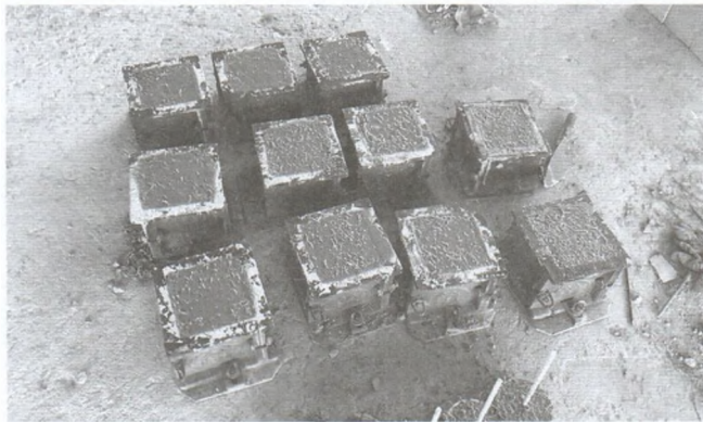
Hình 2.1: Thử nghiệm độ sụt và đúc mẫu thử cường độ chịu nén của bê tông
