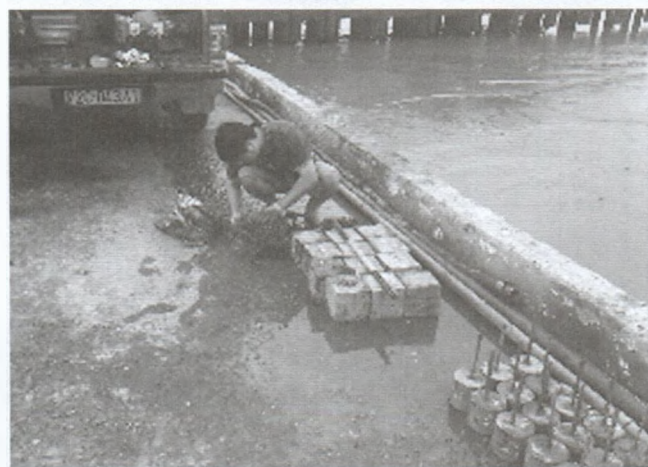
Hình 2.2: Bảo dưỡng các mẫu thử tại Gành Hào, Bạc Liêu và Bình Đại, Bến Tre
